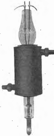
Fig. 4 - Triodo Philips Z 82 con refrigerante.
